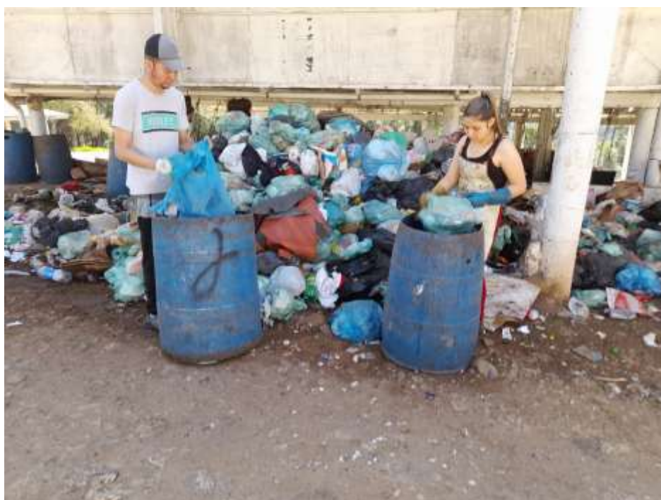
Figura 31 - Obtenção das amostras com volume conhecido
