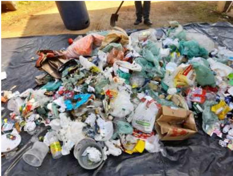
Figura 32 - rompimento dos sacos e homogeneização dos resíduos
