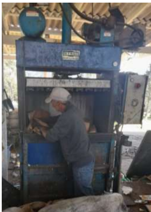
Figura 20- Compactação e embalagem dos materiais recicláveis
